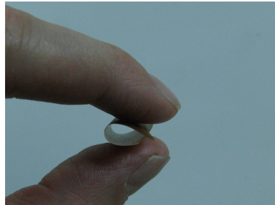
図 6. ポリイミド/セラミックス複合材の外観。指で曲げても割れることのない柔軟性を維持している。
