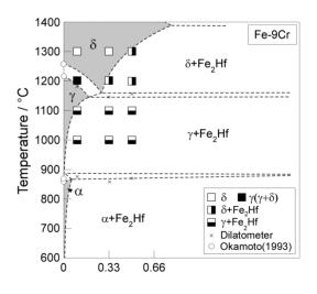
図1 Fe-Cr-Hf3元系合金における 9Cr 等 濃度縦断面状態図
