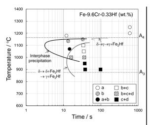
図 2 Fe-9.6Cr-0.33Hf 鋼のδ→γ+Laves 共析 反応経路における析出挙動(TTT 図)
