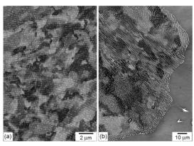
図3(a) Fe<sub>2</sub>Hf-Laves 粒子の相界面析出(微細点列状)組織及び(b) Fe<sub>2</sub>Ta-Laves 粒子のパーライト析出(層状)組織
