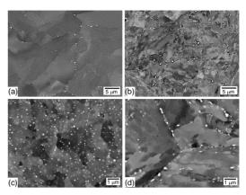
図 4 Fe-Cr-Hf 鋼の相界面析出組織(a, c) 及び既存の高 Cr フェライト系耐熱鋼 Gr.91 (b, d))組織の高温における安定性
