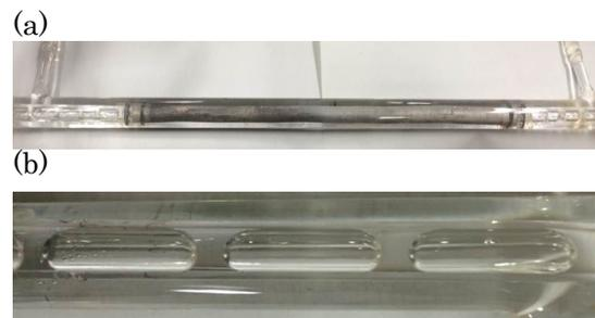
図 3 (a) 内壁アルミナに加工したアルミニウム反応管 (ガラス製ジャケット付) と (b) 反応器供給前の Taylor flow 写真
