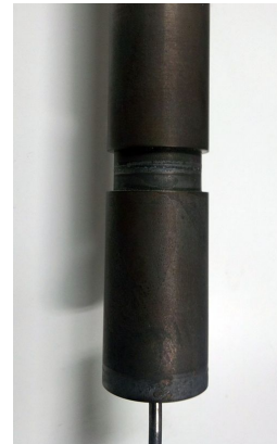
図 3 液相型透過装置試料溶接部外観
