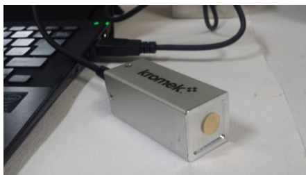
図 4 . CdZnTe 半導体検出器による測定
