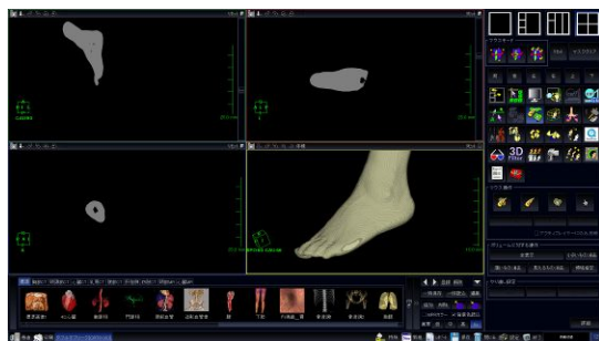
図 3 . DICOM 形式に変換された非接触三次元計測機の点群データを医療用ワークステーションで解析している
