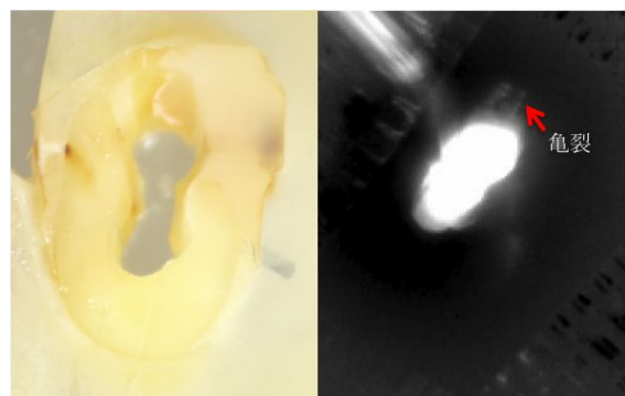
図1. 赤外線サーモグラフィ像 右: 光学顕微鏡像 左: 赤外線サーモグラフィ像
