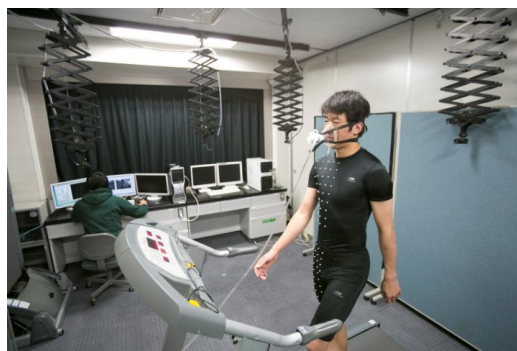
図3 エネルギー代謝測定による運動効果促進ウェアの効果検証実験の様子
