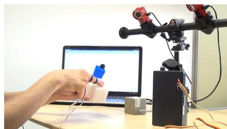
図7 触覚重畳による質感変調システム
