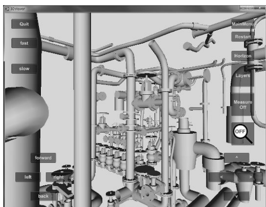
図2 配管の3次元形状データ
