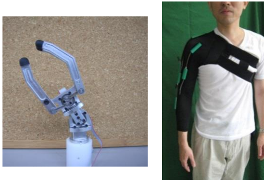
Fig. 3 開発した義手と肩肘動作計測装置
