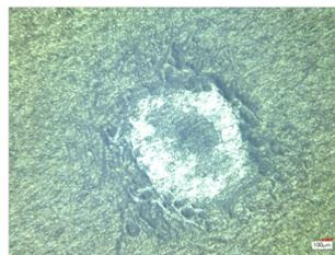
図 3 . 高強度 THz 波照射によって形状が変化した液晶物質 5CB の偏光顕微鏡写真
