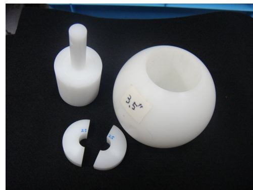
図1 制作した金放射化ボナー球検出器(直径3.5インチのもの)。左上のアタッチメントの中に金板が格納されている。左下の補助アタッチメントも用いて、球殻の中心に隙間なく設置される。誘導放射能はアタッチメントごと HPGe 検出器で測定する。
