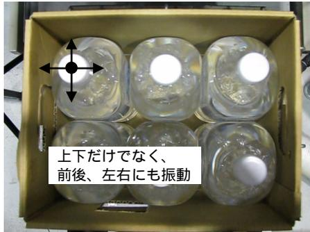
図5 高速度カメラによる加振中におけるペットボトルの撮影画像
