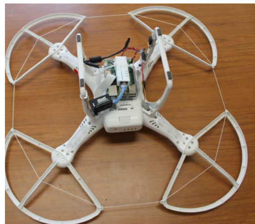
図 6 ドローンによるローカル情報共有システム (ドローン背面)
