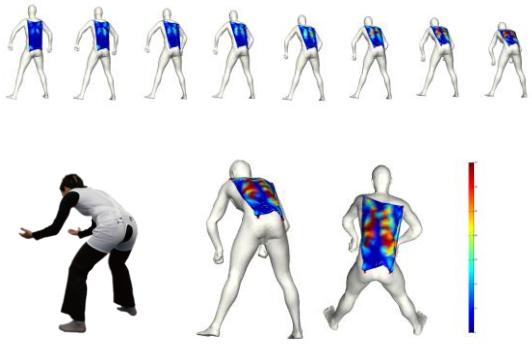
図6 スーツ型機器装着時の圧力分布推定結果
