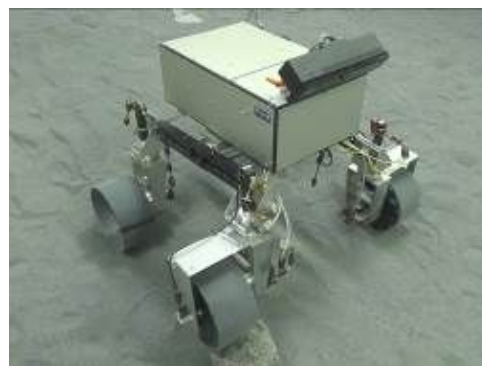
図2: 航法誘導システム検証用ローバテストベッド
