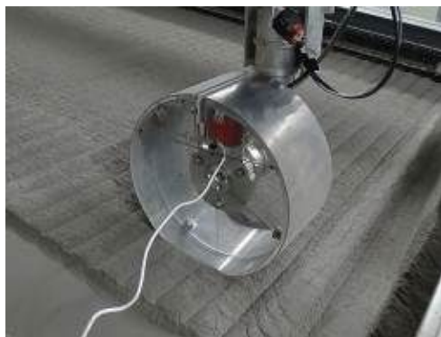
図1: 応力計測車輪モジュールを用いた走行実験
