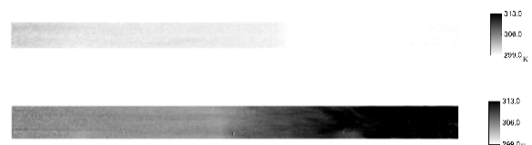
図3. TSPによる観測窓上の入射衝撃波(上)と反射衝撃波(下)通過時の温度分布の可視化結果
