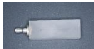
図 1. 試験切削に用いたレジンブロック
