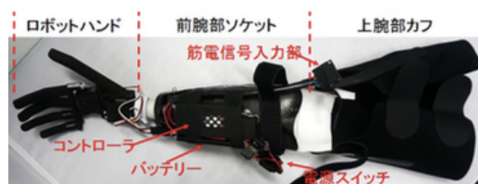
図3 簡易型筋電義手
