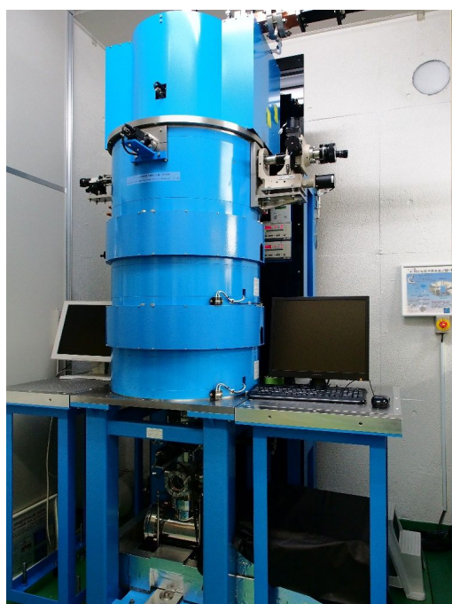
図3 相対論的フェムト秒電子線パルスを用いた超高速電子顕微鏡実証機の写真
