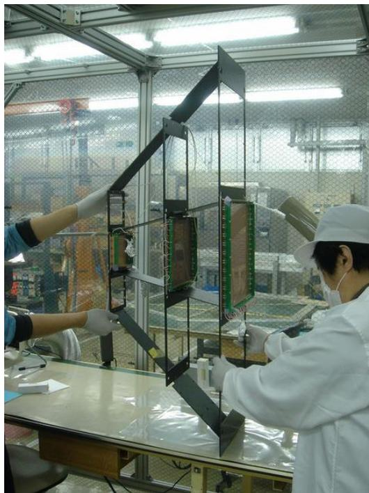
図 2: CFRP 製フレームにとりつけた GTR の 1 モジュール分 (検出面積 100mm 角、200mm 角、300mm 角で 1 セット)
