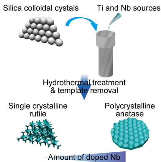
Fig. 2. メソポーラス Nb ドープ TiO 2 の作製手法
