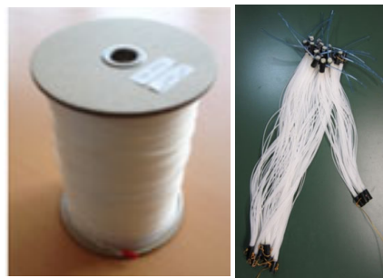
図1 細径人工筋(左)と多繊維化(右)
