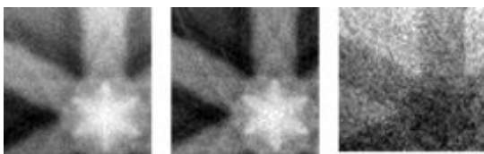
図2 Al添加(左)、無添加(中) Y_2Ti_2O_7 の酸素 K 線によるイオン化チャネリング図形。右図はその除算像で、このパターンから Al 添加に伴う酸素空孔サイトが同定される。
