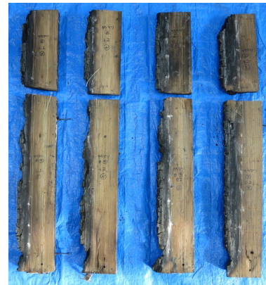
図3 2時間加熱後9時間で脱炉した試験体の燃え止まり部のカラマツ荷重支持部への接触面の状況
