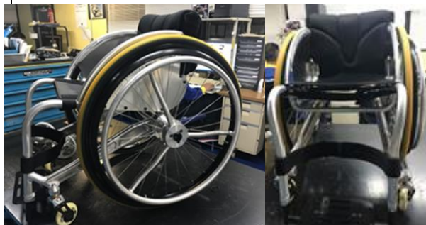
図 9 本研究成果のボウリング用車椅子
