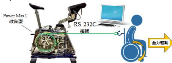
図 2 車椅子推進パワー計測の概要
