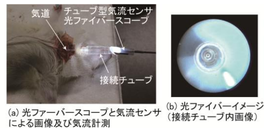
図7 ファイバースコープと一体化したチューブ型気流センサ
