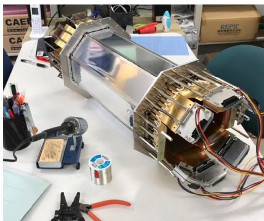
図5 : 製作した Z vertex chamber
