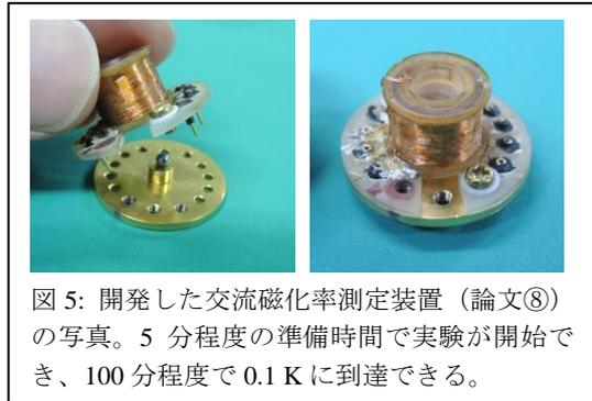
図 5: 開発した交流磁化率測定装置 (論文⑧) の写真。5 分程度の準備時間で実験が開始でき、100 分程度で 0.1 K に到達できる。
