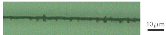
図 1 波長 1.064 \mu\text{m} 、パルス幅 0.5 ns のレーザーパルスの照射によってシリコン基板内部に形成された改質線
