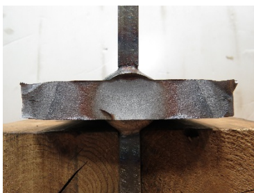
図-11 停留した疲労き裂
