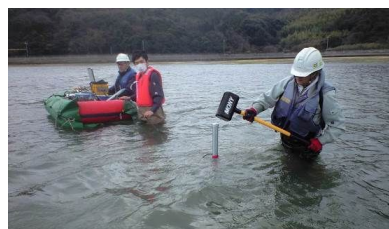
図-9 ハイドロフォンを使った MASW 実施状況
