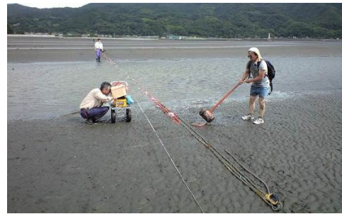
図-1 自然干潟の潮間帯でのジオフォンを使った MASW の実施状況
