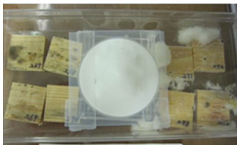
写真2 雨水散布による腐朽進行状況
