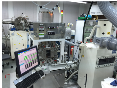
図 2. プラチナ触媒を用いたギ酸表面活性化接合装置の概念図およびその外観
