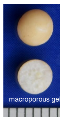
図4 馴養した微生物固定化多孔質ゲル粒子の外観(上)および切断面(下)
