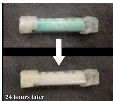
図 2 UV 照射による TCF 充填カラム内のメチレンブルーの光触媒分解
