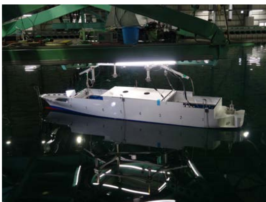
図2 定傾斜状態の船体運動に関する模型実験（高速 Ro/Ro 船）
