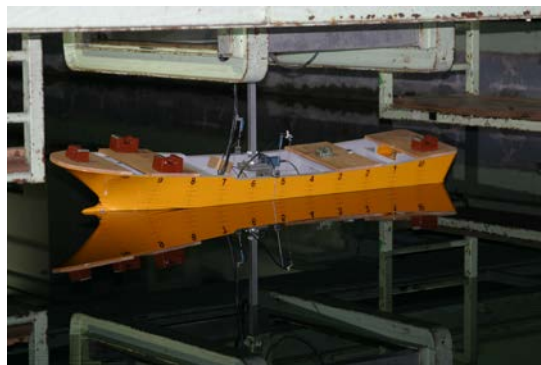
図1 定傾斜状態の船体に作用する波浪強制力に関する模型実験（底びき網漁船）
