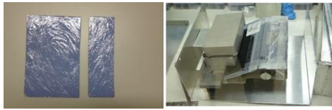
図1 PPS フィルムで覆った IP (左) および タイルに接触させた様子 (右)
