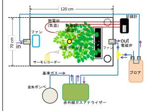
図1 群落光合成測定用同化箱の模式図
