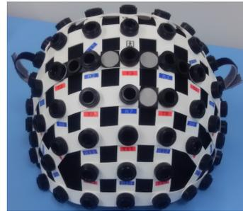
図 1. NIRS 用プローブに光学式トラッキング装置用マーカ (銀色の円形状) を配置
