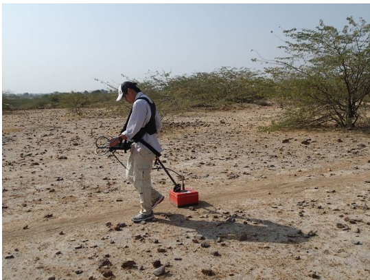
図3 GPR (地中レーダ) 探査の様子
