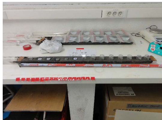
図-5 帯磁率測定用キューブを半載コアに差込んでいる様子
