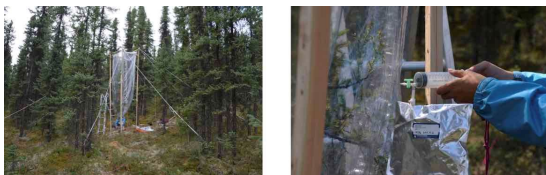
図 5: ^{13}\text{CO}_2 ラベリング チャンバーにて樹冠を覆い (左図) 99.9% ^{13}\text{CO}_2 を注入 (右図)
