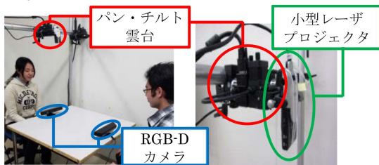
図 7：複数ユーザの場合のシステム構成例
