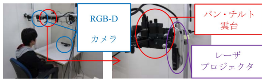
図 6：単一ユーザの場合のシステム構成例
