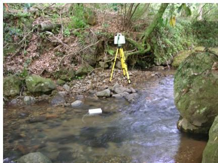
写真 1 河岸に設置された TLS
