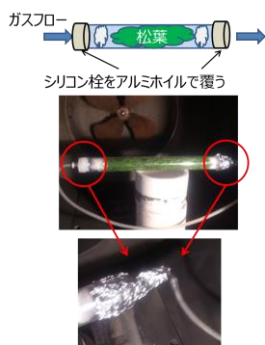
図6 大型マルチモード共振器内の松葉試料設置状況
