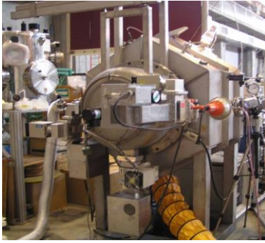
図2 大型マルチモード共振器の外観
