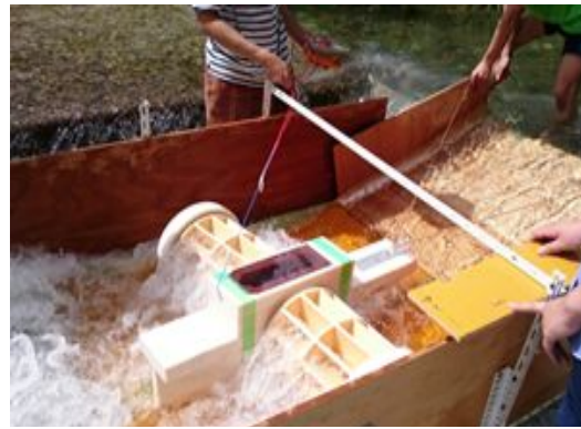
図2. フロート式発電の実験風景
