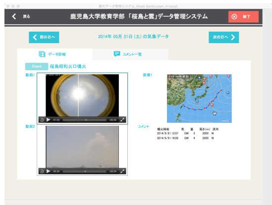
図3：カレンダーから選択した個々のイベント提示の例 (動画1：全天カメラ動画, 動画2：従来カメラ動画, 画像1：実況天気図 (15時), コメント：気象台観測された噴火状況, PC用 FileMaker Pro で表示)
