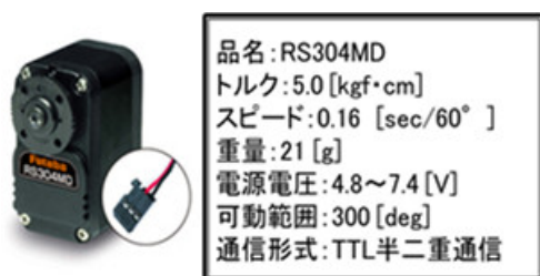
図1 使用したサーボモータの外観と仕様
