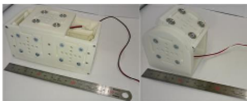
図2 製作した直動(左)と回転ユニット(右)
